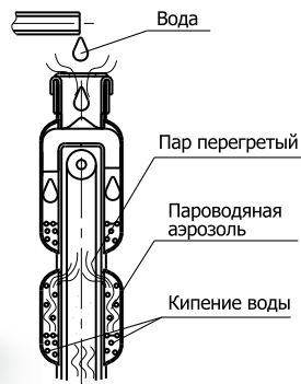
Принцип работы блока парогенератора:
